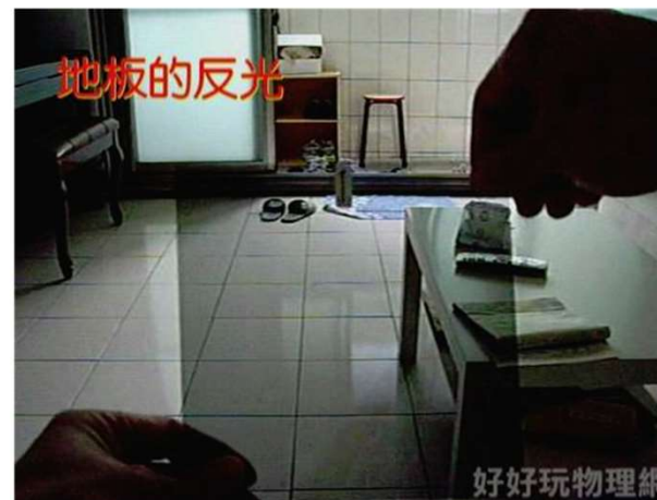
↑偏振方向改為垂直，反射光就幾乎看不見了。 想一想：經由地板反射的光線，偏振方向為何？與木地板相同嗎？
