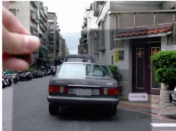
↑偏振方向水平，車窗反射的光線相當明顯。
