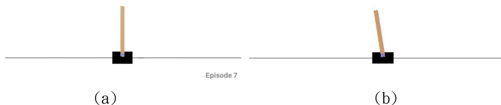
圖(一) A Cartpole system: (a)平衡狀態, (b)不平衡態
