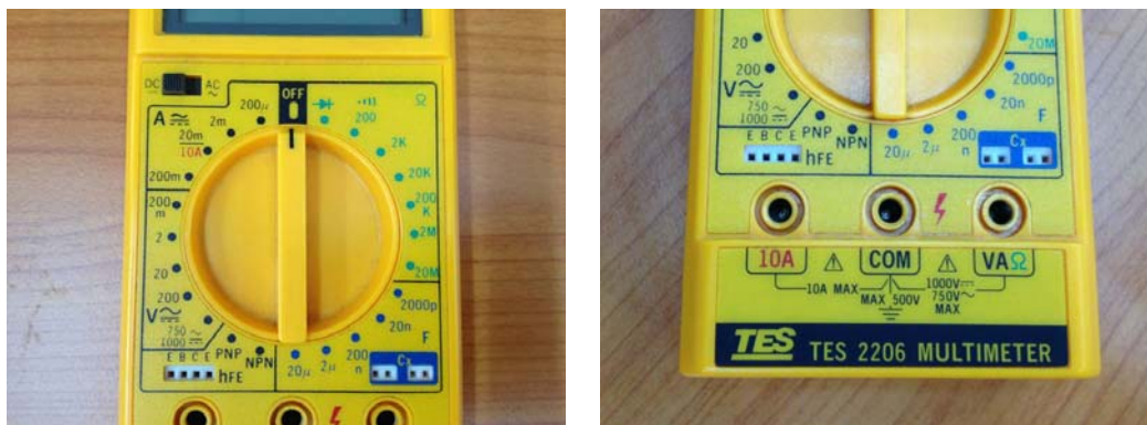
(圖 4) TES2206 功能範圍選擇開關、【10A】【COM】【VAΩ】測試插座
